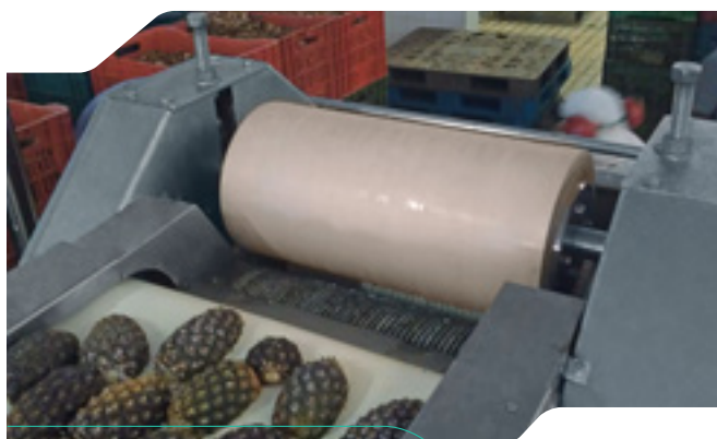
6 - Despolpadeira de frutas com discos dentados e alinhadores
